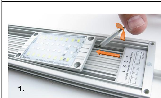
Anheben und Entnehmen des Moduls in zwei Schritten: Den kurzen, gummierten Schenkel des Spezial-Schlüssels in die Gewindenuten einführen und das Modul "heraushebeln"
