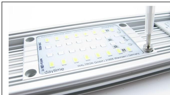
Lösen und Entnehmen aller Schrauben
